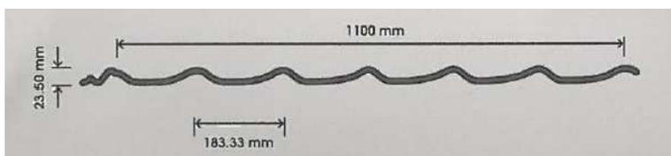
Ces panneaux destinés à la couverture de toitures de bâtiments à usage domestique et agricole ont la particularité de restituer l'aspect de la tuile classique.
